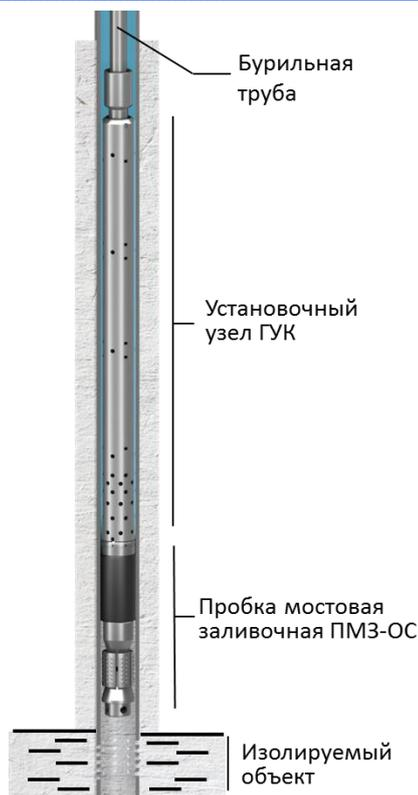
Рис. 3. Схема применения ПМ(3)-ОС
