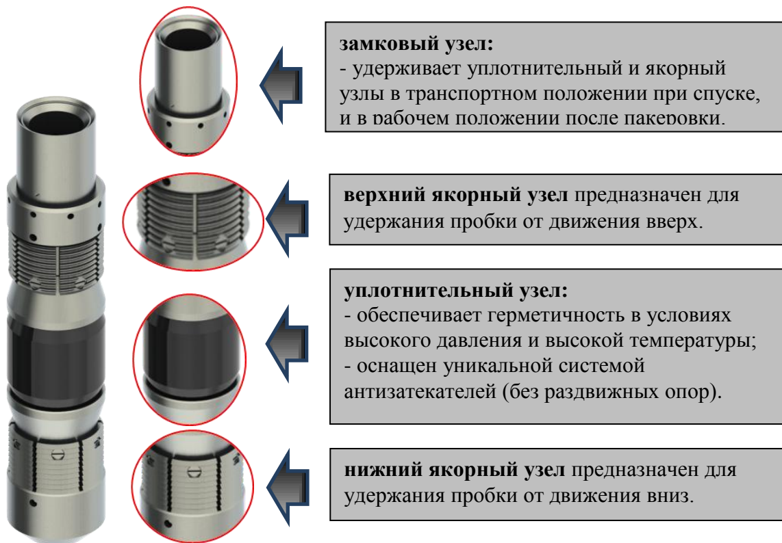
Рис. 6. Устройство пробки мостовой электромеханической ПМЭ
