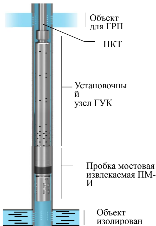
Рис. 2. Установка пробки ПМ-И
