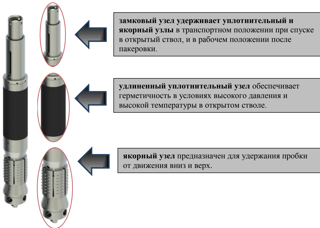
Рис. 8. Устройство пробки ПМЗ-ОС
