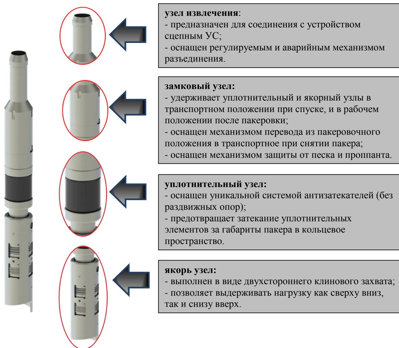
Рис. 1. Устройство пробки мостовой извлекаемой ПМ-И
